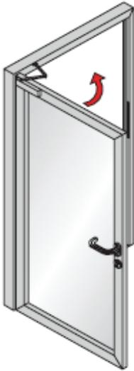
Der Türschließer bewegt den Türflügel automatisch in die geschlossene Stellung zurück. Einige Türschließer halten den Türflügel in geöffneter Stellung ganz auf, wie z.B. Feststellanlagen bei Brandschutztüren. Zum Schließen muss die Tür einmal in Schließrichtung gezogen werden, danach schließt sie wieder automatisch.
