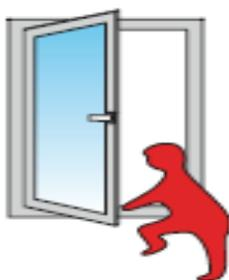
Zum Schutz von Personen ist der Flügel gegen Aufdrehen zu sichern, z. B. mit Dreh Sperre oder abschließbarem Bedienungsgriff.
